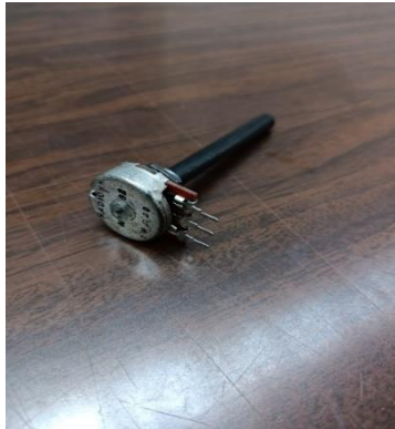
Εικόνα 33: Γραμμικό Ποτενσιόμετρο με μέγιστη αντίσταση 2\Omega
