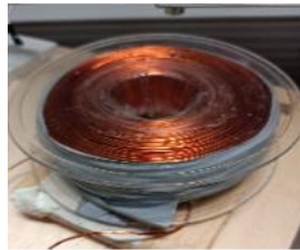
Εικόνα 22: Πηνίο/Διεγέρτης και θέση μαγνήτη
