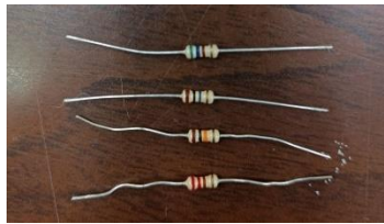
Εικόνα 36: Είδη Αντιστάσεων στο Breadboard
