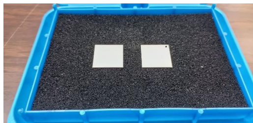
Εικόνα 15: Το πιεζοηλεκτρικό υλικό που είναι σημαδεμένο συμβολίζει τη θετική φόρτιση και το μη σημαδεμένο την αρνητική φόρτιση
