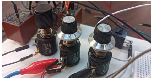
Εικόνα 29: Αντιστάσεις Κυκλώματος με εύρος τιμών 0-10k \Omega
