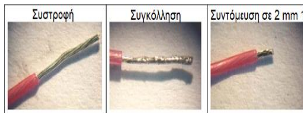
Εικόνα 20: Στάδια Συγκόλλησης
