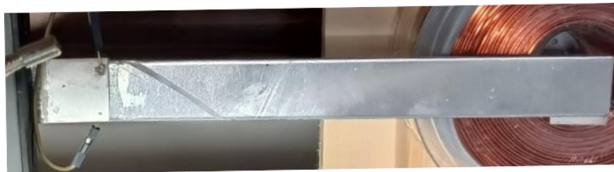
Εικόνα 23: Δοκός μαζί με πιεζοηλεκτρικό επίθεμα και Πηνίο
