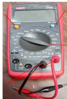
Εικόνα 39: Πολύμετρο με χρήση Ωμόμετρου
