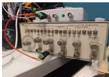
Εικόνα 46: Γεννήτρια Παλμογράφων Hewlett- Packard's 3312A (HP)
