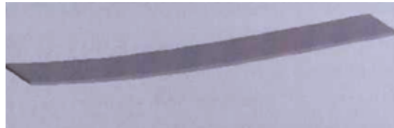
Εικόνα 54 Δοκός στον πρώτο τρόπο δόνησης [21]
