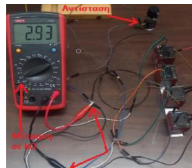
Εικόνα 70 Μέτρηση Αντίστασης Πειράματος
