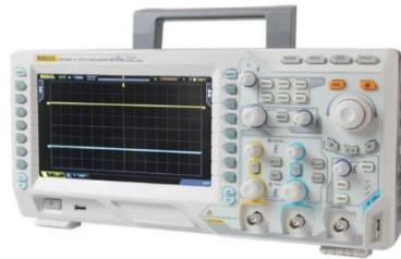
Εικόνα 50: Rigol DS2202A 200MHz Digital Oscilloscope
