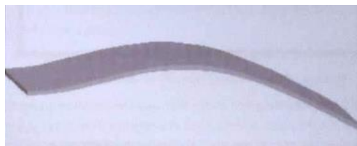
Εικόνα 55: Δοκός στον δεύτερο τρόπο δόνησης με έναν κόμβο [21]
